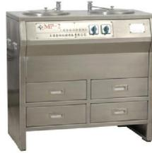
MP-2A 型双盘无极变速金相试样磨抛机是本公司根据用户要求新设计制造的一种新型磨抛机，该机外形新颖美观，转动平稳，噪音低，它的机架整体和集污盘、罩、盖等均采用不锈钢板制成，经久耐用，维护保养极为方便，在使用时只需更换磨抛机或抛光盘，就能完成各种试样的粗磨、细磨、干磨、湿磨及抛光等道工序，是一种极为理想和完善的最佳金相制样设备。
