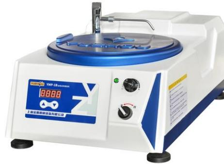
在金相实验室，金相试样的制备过程中，试样的预磨、抛光研磨是多道必不可少的程序。本机是采用单片机控制的金相试样磨抛机，集污盘和罩采用 ABS 材料整体制作，是具有新颖美观外形的最新产品。磨盘无级调速，也可四速控制，正向或反向旋转，确保了试样的平整与光洁。电机为直流无刷电机，使用寿命长且噪音低；配备供水系统可防止因试样过热而破坏金相组织，磨盘背部挡水圈设计与盆腔底部挡水圈结构双重挡水，更好保护内部电器系统；它具有传动平稳、噪音小、操作及维护方便等优点，适用于多种材料的预磨和抛光要求。
